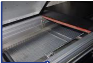
Zona de precalentamiento con aire caliente de 1800 mm de longitud
