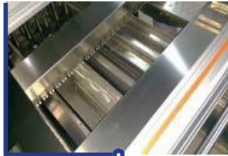
Solder Pot (Olla) con doble ola totalmente de aleación de Titanio para proceso libre de plomo (Lead Free)
